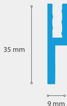
L'I-35 est un profilé léger en aluminium pour permettre de créer des caissons encastrés qui seront recouverts sur une face de toiles imprimées à l'aide d'un tendon cousu en silicone.
